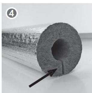
PL W celu zminimalizowania strat ciepła przewodów rurowych przebiegających poziomo, rozcięcie powinno znajdować się w dolnej części przewodu rurowego.
