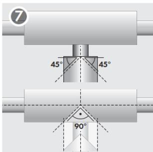
**PL** Przy trójniku w rurociągu o kącie 90°: należy otulinę odchodzącego przewodu instalacji przyciąć na końcach z obu stron pod kątem 45° tworząc zaokrąglony koniec. W środku otuliny głównego przewodu instalacji wyciąć klin pod kątem 90°. Szerokość wyciętej części powinna odpowiadać zewnętrznej średnicy otuliny.
